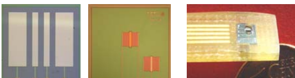
Chip del sensor de conductividad y el de pH Chips encapsulados en un PCB
