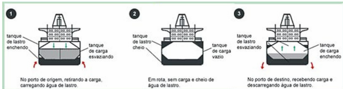
Figura 1 – O Processo da Água de Lastro Fonte: Porto de Santos (2009)
